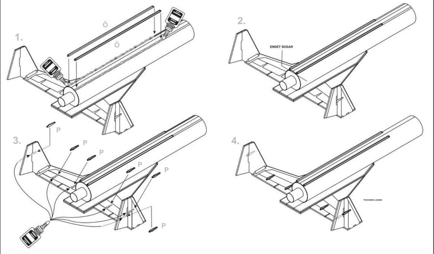
ZUSAMMENBAUEN UND INSTALLIEREN DES OBEREN MOTORGEHÄUSES
