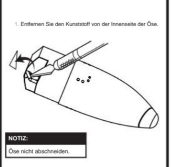
Befestigen Sie den Fallschirm und das Schockkabel
