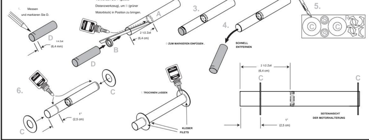
Karosserierohr markieren und Motorlager einbauen
