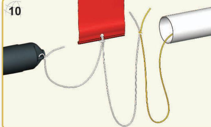
**Germany** Mit einem spitzen Gegenstand sollte ca. 20 mm von einem Ende des Strömers ein Loch durchgestoßen werden. Das elastische Schockband zu einer Schlaufe formen und das andere Ende des Strömers wie abgebildet hindurch ziehen.
